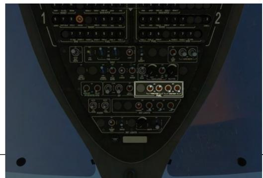
Es gibt 4 Kraftstoffpumpen. Die beiden Transfer (XFER)-Pumpen fördern den Kraftstoff vom Haupttank (Mitte) in die Vorratstanks. Beide Transferpumpen fördern unabhängig voneinander Kraftstoff vom Haupttank in beide Vorratstanks.
