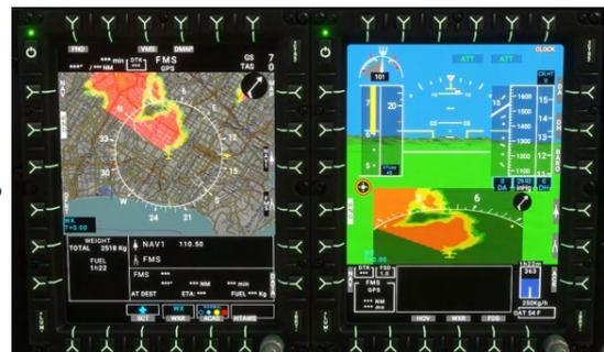
Das Wetterradar wird über das WXRCP-Bedienfeld in der der Mittelkonsole gesteuert. Der Hauptknopf hat 4 Funktionen (OFF, Standby, TEST, und Ein). Der STBY-Modus wird verwendet, wenn man auf dem Boden ist. Der TEST-Modus wird verwendet, um ein Testmuster auf den Seiten FND und NAVD
