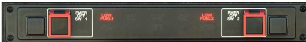
Die Warneinheit enthält Warnungen bei niedrigem Kraftstoffstand die sich nur auf die Vorratstanks beziehen. Die roten Schutzvorrichtungen können angehoben werden, um im Falle eines Brandes eine Kraftstoffnotabschaltung für das Triebwerk zu aktivieren.
