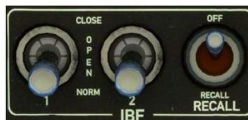
**CLOSED (geschlossen):** Die Bypass-Klappen sind geschlossen und öffnen sich nicht automatisch. Die Filter schützen den Motor, aber im Falle von OEI öffnen sich die Bypass-Klappen nicht automatisch, so dass nicht die volle Leistung zur Verfügung steht.
