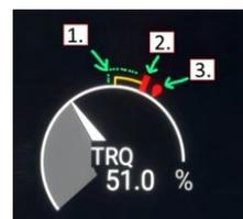
Über Vy+5kt wird die Startleistung allmählich verschwinden. Die Grenzwerte der Triebwerksanzeigen und der FLI verschieben sich entsprechend der Tabelle:
