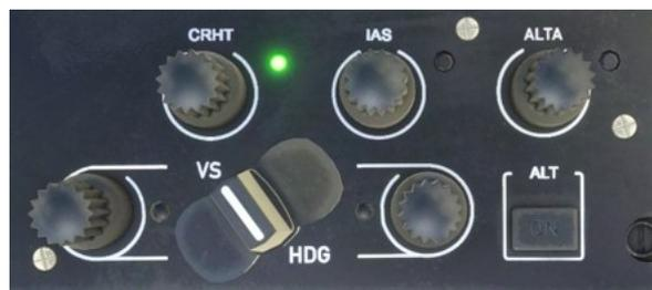
In den folgenden Collective-Mode (CRHT, IAS, ALTA, VS/FPA) verwendet der 4-Achsen-Autopilot die Collective-Steuerung, so dass Sie diese nicht verwenden können, es sei denn Sie halten COLLECTIVE TRIM RELEASE gedrückt.
