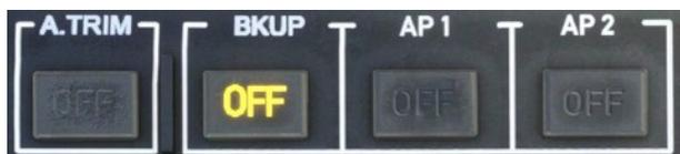
**A.TRIM** oder AUTO TRIM ist ein System, das die Trimm- und Rückstellkräfte der Cyclic Control steuert. Es ermöglicht dem Piloten, den Hubschrauber freihändig zu fliegen und über einen CYCLIC TRIM RELEASE-Knopf oder durch manuellen Druck auf die Federn des Trimmsystems einzugreifen, wodurch die Trimmung entweder pausiert oder nachgeführt wird.
